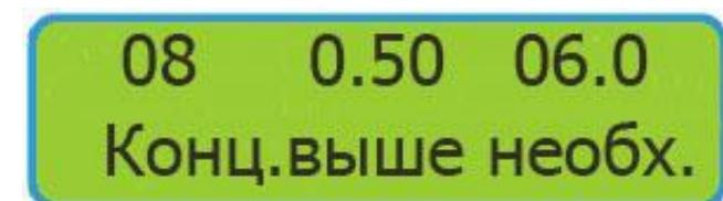
**Если любой из аварийных сигналов, указанных в пп. 1 – 4, не исчезает после выполнения соответствующих рекомендаций по их устраниению, необходимо выключить питание синтезатора выключателем напряжения сети (поз. 12 рисунок 2), а затем снова включить синтезатор в работу следуя всем инструкциям данного руководства по эксплуатации.**
